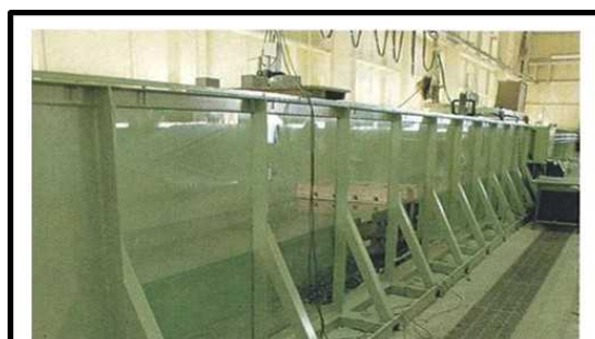
■造波長水路 (50m長水路) (鋼製両面一部強化ガラス張り、50m×1m×1.5m) 一方から造波し、防波堤、護岸などの安定性や消波効果、越波防止効果などを把握するための施設です。
